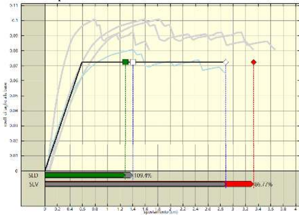
Analisi pushover "Pushover +X Acc" : stima della vulnerabilita' sismica.
