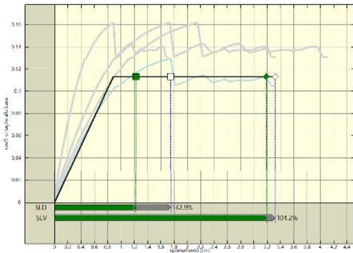
Analisi pushover "Pushover -Y Acc" : stima della vulnerabilita' sismica.
