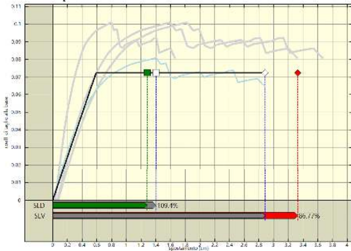
Analisi pushover "Pushover +X Acc - e" : stima della vulnerabilita' sismica.
