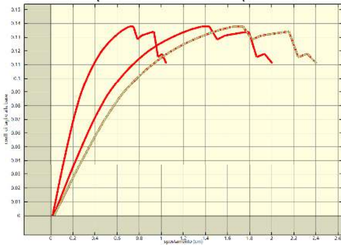
Analisi pushover "Pushover +Y Acc" : curva di capacita'.
