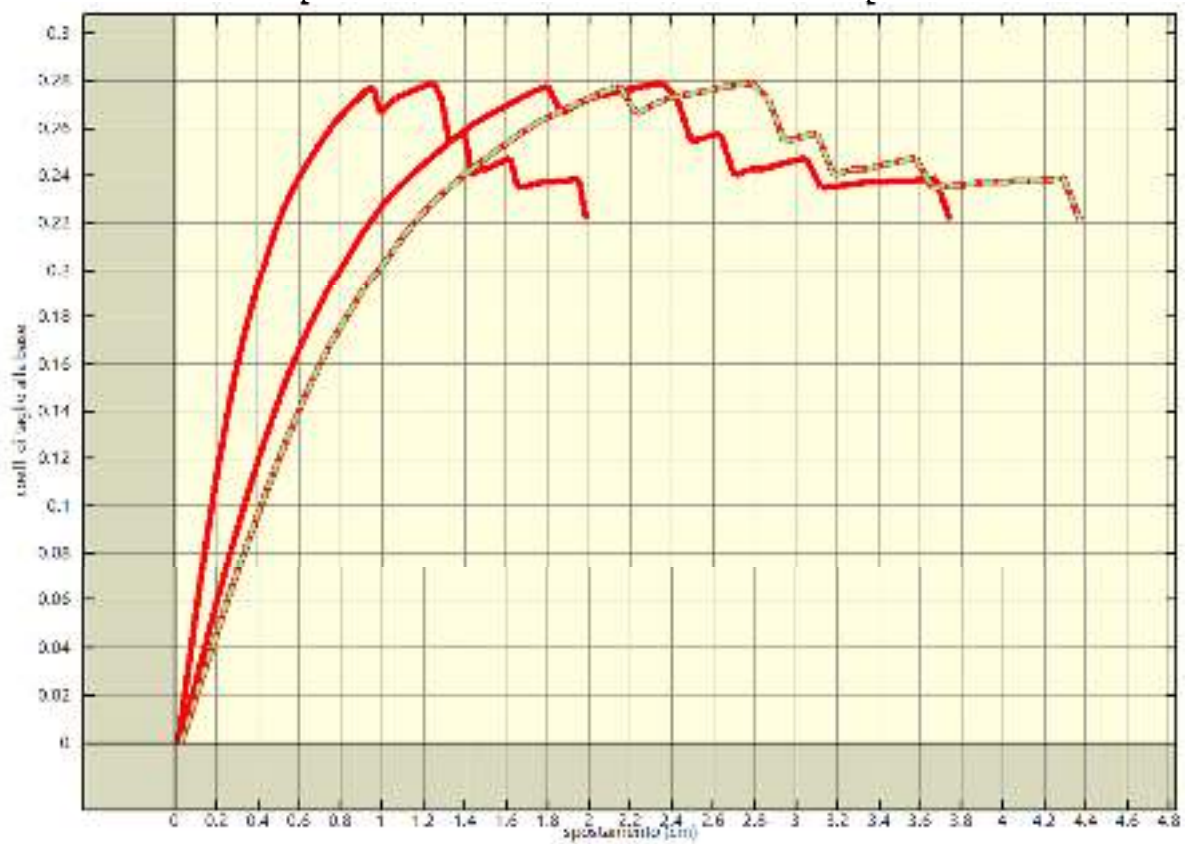
Analisi pushover "Pushover +Y Massa - e" : curva di capacità'.
