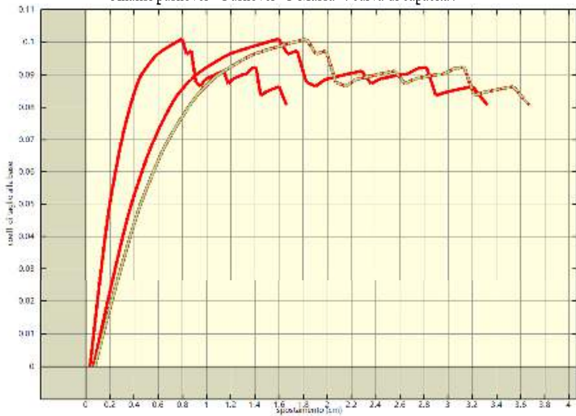
Analisi pushover "Pushover +X Acc" : curva di capacita'.
