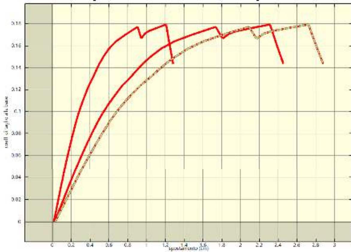
Analisi pushover "Pushover +Y Acc + e" : curva di capacita'.
