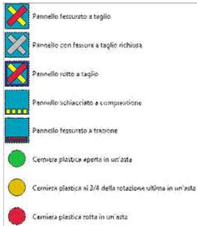
Schema degli indicatori del danno adottati
