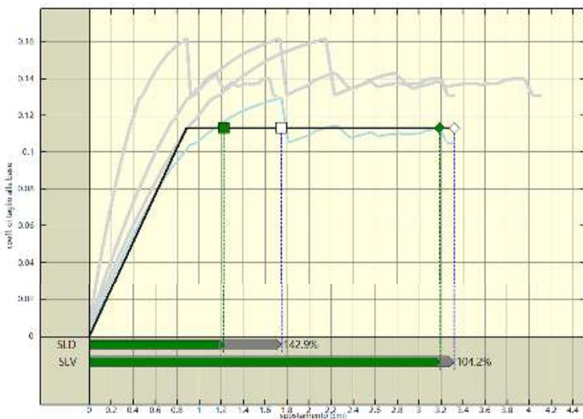
Analisi pushover "Pushover -Y Acc - e" : stima della vulnerabilita' sismica.
