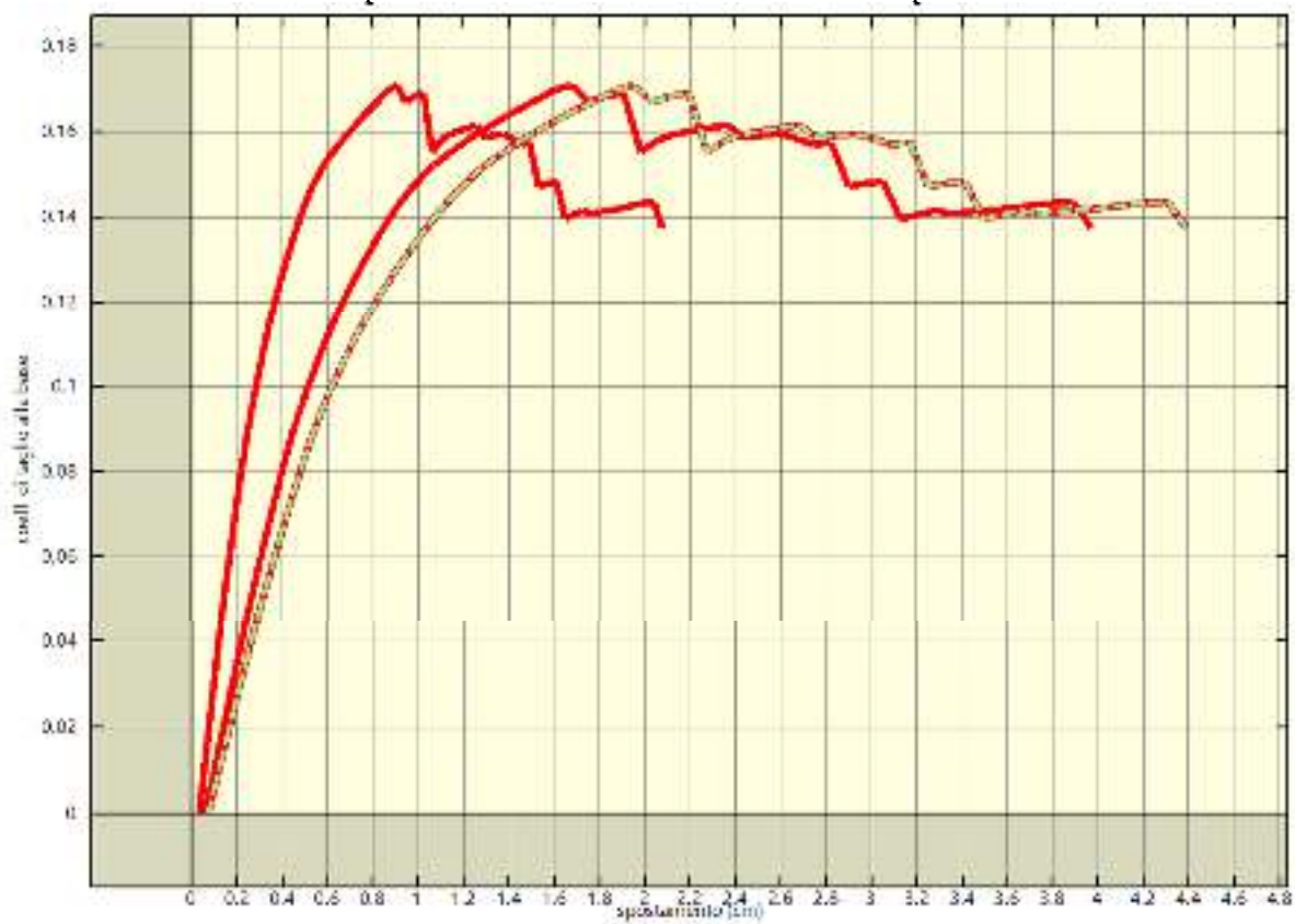
Analisi pushover "Pushover +X Massa + e" : curva di capacita'.
