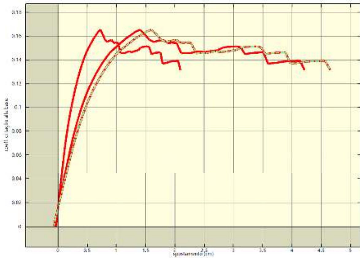
Analisi pushover "Pushover -X Massa" : curva di capacita'.
