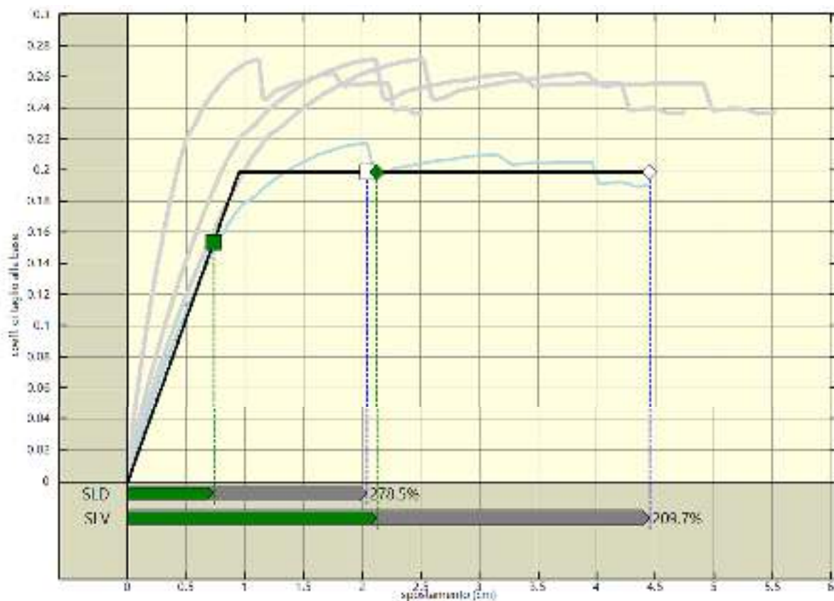
Analisi pushover "Pushover -Y Massa - e" : stima della vulnerabilita' sismica.
