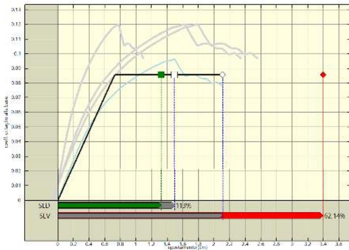
Analisi pushover "Pushover -X Acc - e" : stima della vulnerabilit  sismica.
